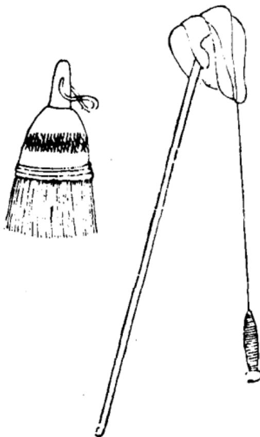
撚綿軸制作小礎或木或石上插細軸長可尺許先用丈頭挂綿左手執父右手引綿上軸懸之撚作綿絲就纏軸上即爲細縷閨婦室女用之可代績紡之工
